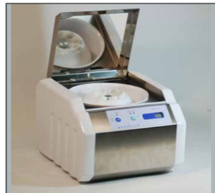
Fig. 16. Centrífuga con rotor girando a velocidad alternada y controlada 2.400 a 2.700 rpm. durante 12 minutos.
