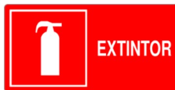
Figura 5.14: Señal de extintor
