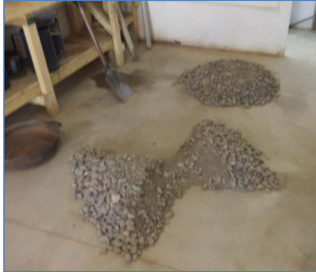
Figura 4.4.- Homogenización y preparación del suelo a ensayar
