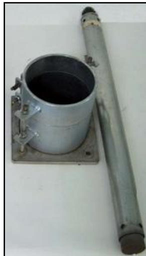
Figura 2.16.- Molde y pisón normalizados para el ensayo Proctor Modificado
