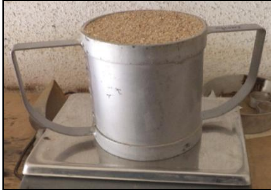
Figura 2.19.- Depósito para calibración de arena de ensayo
