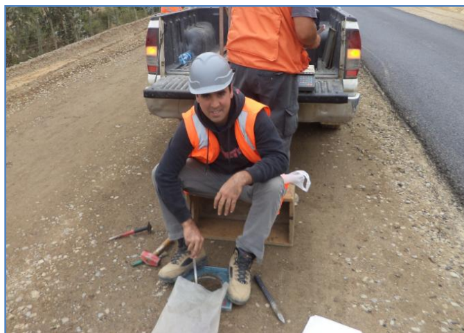
Figura 4.7.- Prueba realizada con el método del cono de arena en la base granular n°1
