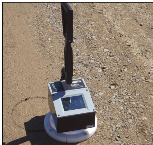
Figura 3.7.- Medición con el densímetro SDG 200 en terreno
