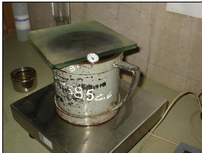
Figura 3.1.- Determinación de la capacidad volumétrica del depósito
