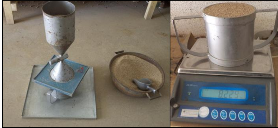
Figura 3.2.- Determinación de la densidad aparente de la arena de ensayo
