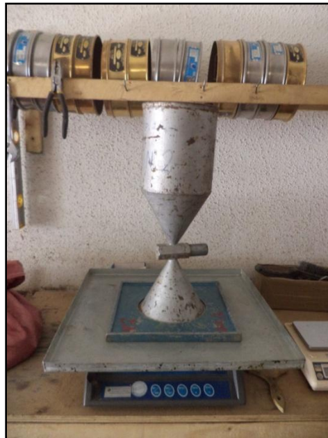
Figura 3.3.- Determinación de la arena que llena el cono basal
