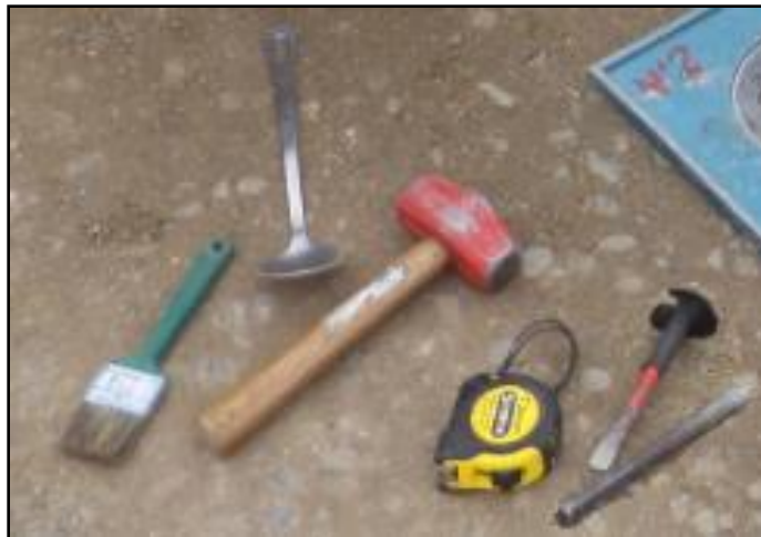
Figura 2.20.- Materiales complementarios para realizar un ensayo de cono de arena
