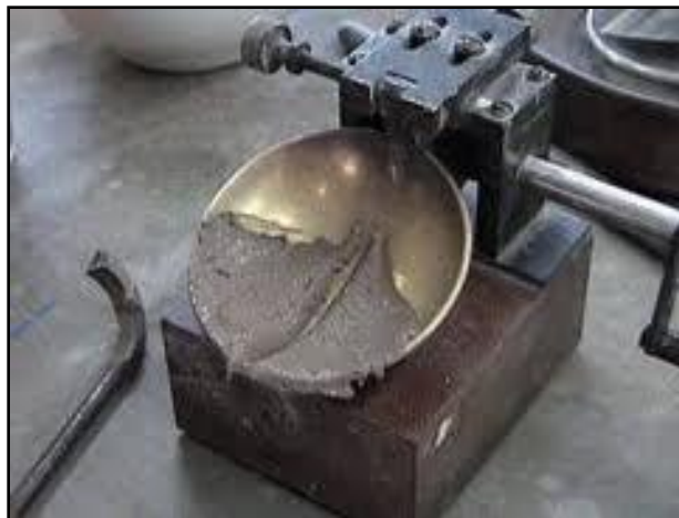
Figura 2.5.- Determinación del límite líquido con la cuchara de Casagrande
