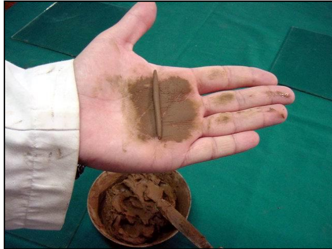
Figura 2.6.- Determinación del límite plástico
