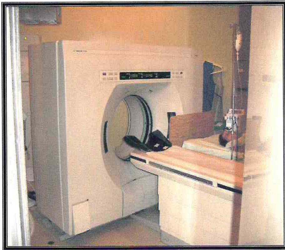
GANTRY ( GENERADOR DE RAYOS X- DETECTORES ELECTRONICOS) Y MESA PARA EL PACIENTE
