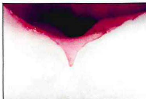
Foto n° 16: Sellante Ultraseal XT plus sin PrimaDry, infiltrado.
