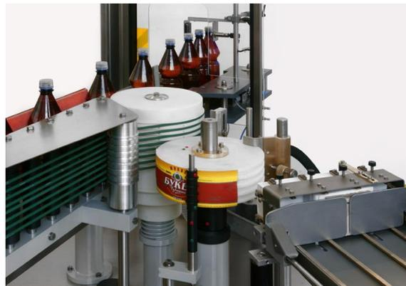
LC – LMF es una máquina etiquetadora lineal para la aplicación en cola fría de una etiqueta parcial o envolvente, sobre contenedores cilíndricos en materiales diferentes, con suministro de cola a rayas horizontales o sobre toda la etiqueta. Las etiquetas son de papel pre-cortado.
