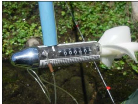
**Figura 17** Correntímetro.
