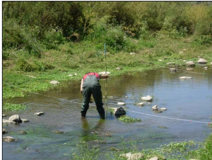
**Figura 15** Medición profundidad con batimétrico.
