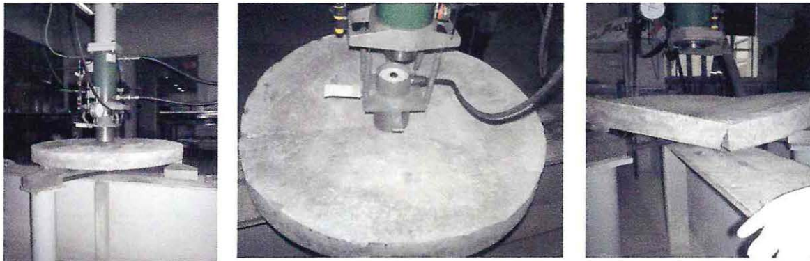
Ensayo 3: Disco con refuerzo Biaxial Geogrid Type 2 a un medio de la altura del disco.
