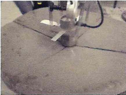
Ensayo 16, 17 y 18: Discos con refuerzo Geotextil Propex 351 a un medio de la altura del disco. DESCARTADOS
