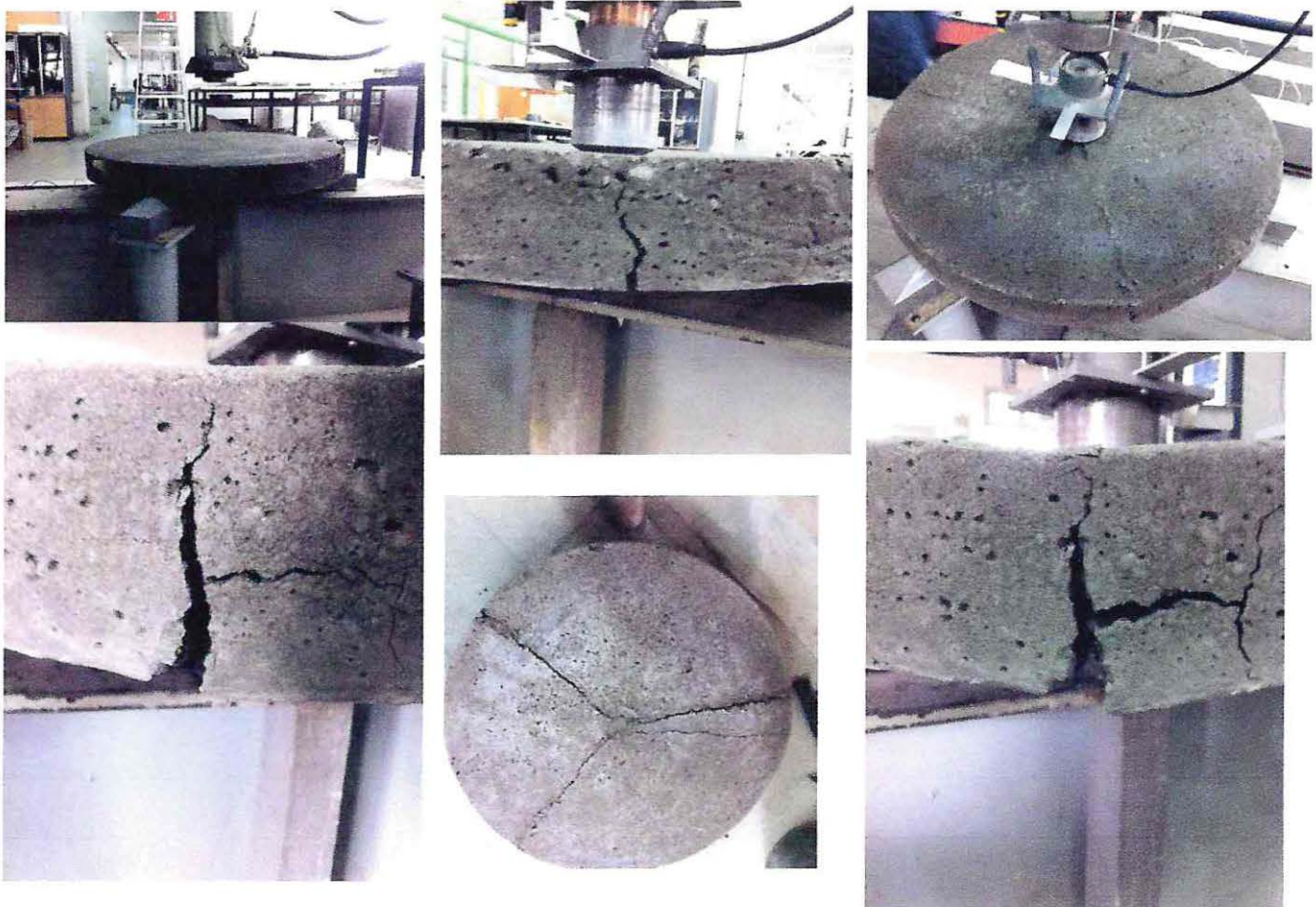
Ensayo 34 y 35: Discos con refuerzo Biaxial E'grid 2020 a un tercio de la altura del disco.
