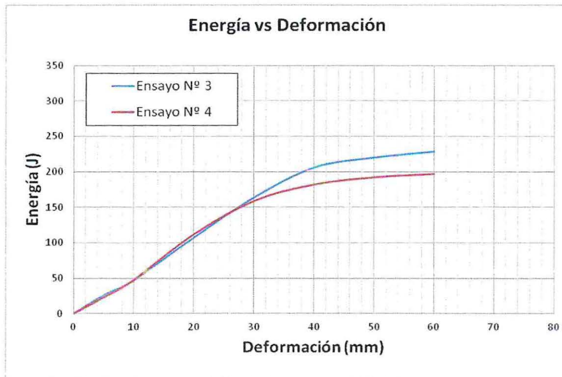
Gráfico 4.38 Comparación de la Absorción de Energía vs Deformación Ensayos Nº 3 y 4 hasta deformación máxima.
