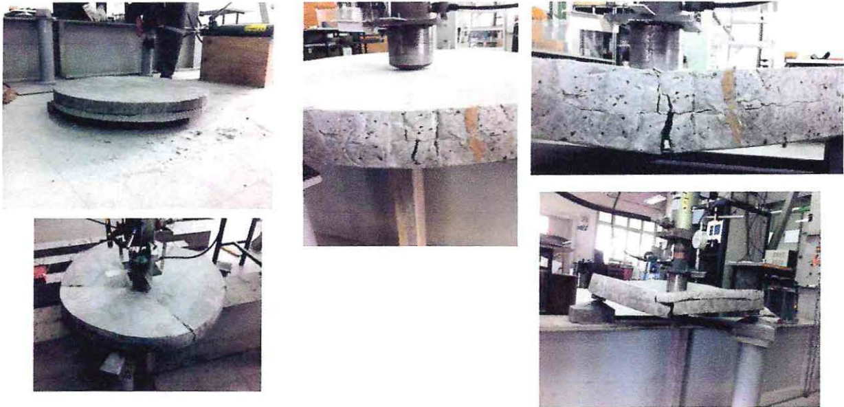
Ensayo 34 y 35: Discos con refuerzo Biaxial E'grid 2020 a un tercio de la altura del disco.
