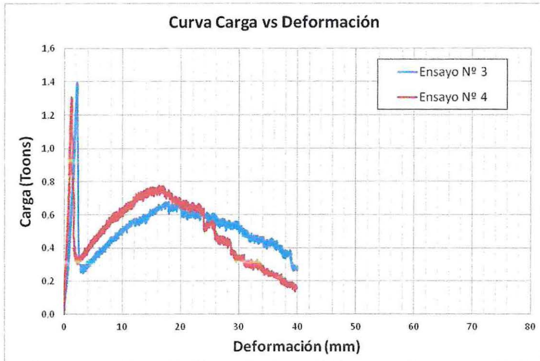
Gráfico 4.37 Comparación Disco reforzado con Biaxial Geogrid Type 2 (1/2H) y Disco reforzado con Biaxial Geogrid Type 2 (1/3H) hasta 40 mm de deformación.
