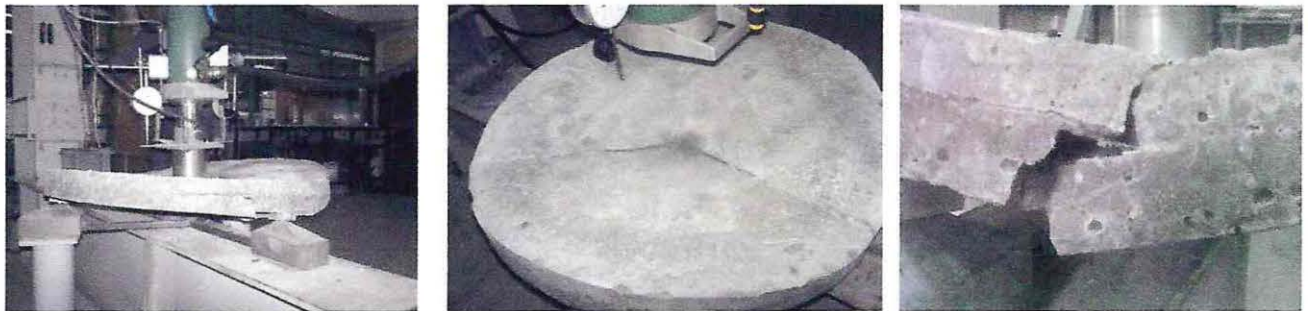
Ensayo 6: Disco con refuerzo Geotextil Propex 601 a un tercio de la altura del disco.
