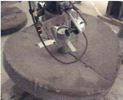
Ensayo 16, 17 y 18: Discos con refuerzo Geotextil Propex 351 a un medio de la altura del disco. DESCARTADOS
