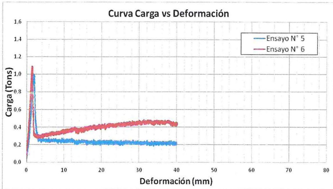
Gráfico 4.42 Comparación Disco reforzado con Geotextil Propex 601 (1/2H) y Disco reforzado con Geotextil Propex 601 (1/3H) hasta 40 mm de deformación.
