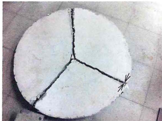
Figura 4.1- Punto de medición de la grieta en el disco
