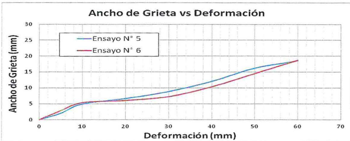
Gráfico 4.45- Relación entre Ancho de Grieta y Deformación del Ensayo N° 5 y 6 hasta deformación máxima.
