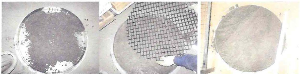
Figura 3.7- Fabricación muestras de mortero proyectado con refuerzo de geogrilla.
