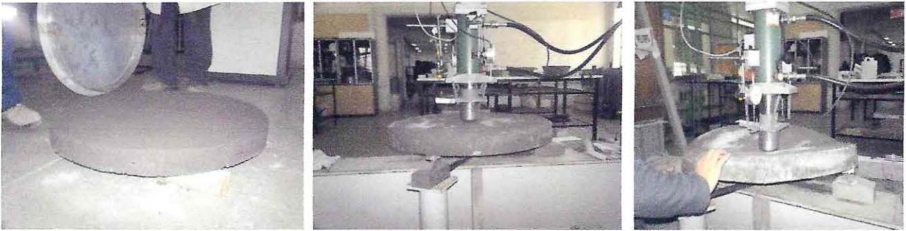
Ensayo 2: Disco sin Refuerzo
