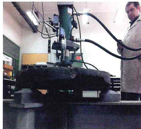
Ensayo 31: Discos con refuerzo Biaxial Geogrid Type 2 a un medio de la altura del disco. DESCARTADO
