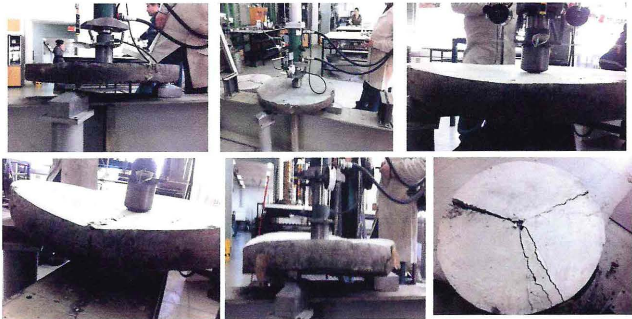
Ensayo 22, 23 y 24: Discos con refuerzo Biaxial E'grid 3030 a un medio de la altura del disco.
