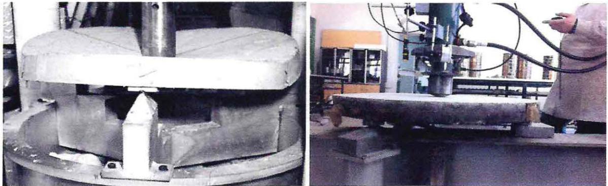
Figura 3.1- Dispositivo de Soporte (Ref: ASTM C1550-12a)
