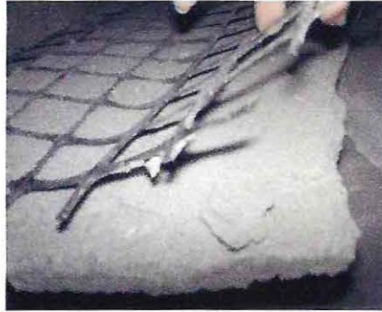
Ensayo 13, 14 y 15: Discos con refuerzo Biaxial Geogrid Type 2 a un tercio de la altura del disco. DESCARTADOS
