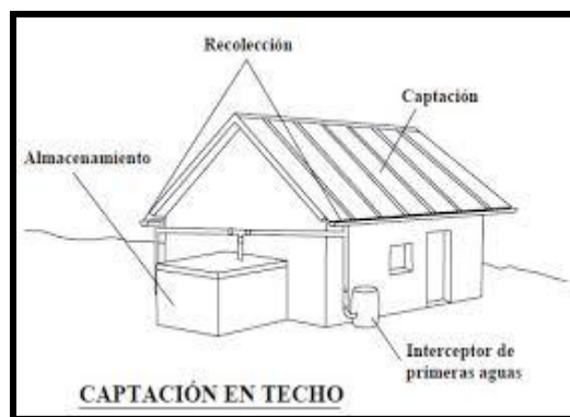
FIGURA N° 9: PARTES DE UN SISTEMA DE CAPTACIÓN DE AGUA LLUVIA DESDE TECHO. FUENTE: HTTPS://ESTOESAGRICULTURA.COM/CAPTACION-DE-AGUA-DE-LLUVIA-EN-TECHO/
