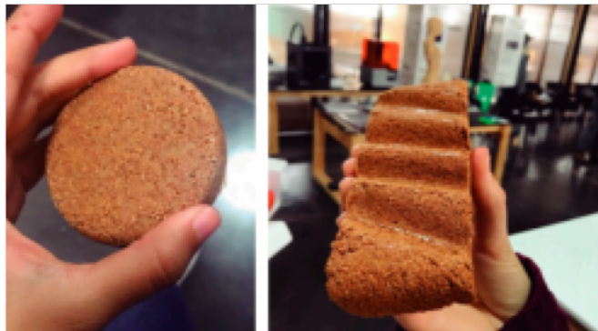
Figura 19: Experimentación de material compuesto a partir del aserrín de corcho. Fuente: Elaboración propia
