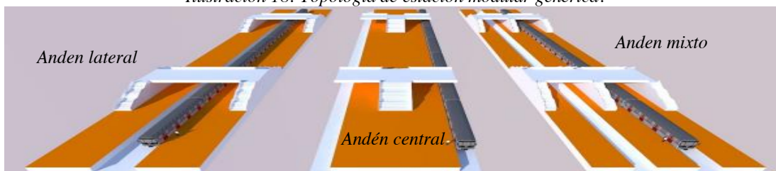
Ilustración 18: Topología de estación modular genérica.
