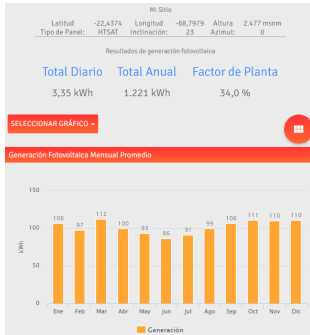
Figura 39: Producción anual de un panel en un punto cercano a una minera tipo. ( http://solar.minenergia.cl/ )
