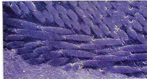
Fig. 4. Sección de dos capas entrecruzadas de Vectris Single de una corona Targis Vectris.
