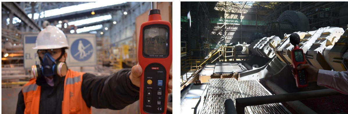
Figura 10 y 11: Registro fotográfico de la toma de muestras con decibelímetro, demostrando la exposición de riesgo de los usuarios del sistema.
