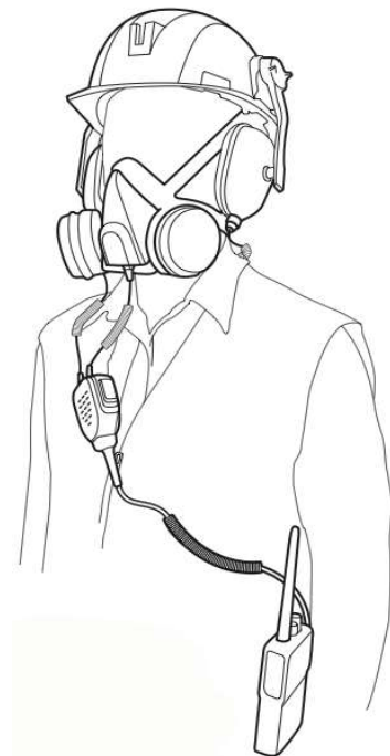
Figura 14: Diagrama explicativo del manual de uso, advirtiendo la disposición correcta del encaje de las piezas.
