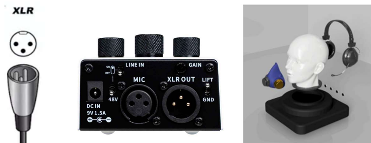
Figura 10: Conector XLR y tablero básico de audio planteado como solución inicial. Explosión del prototipo y sus componentes externos.
