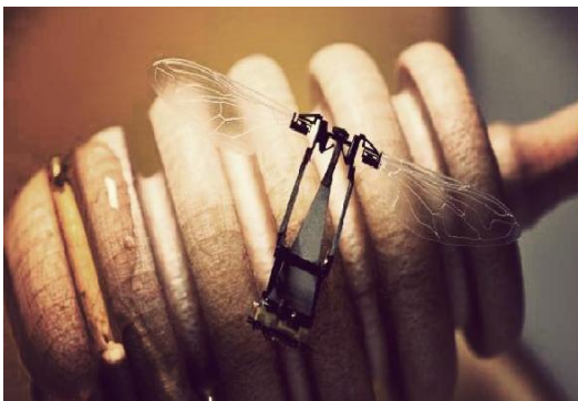
Figura N°6 Abeja robótica polinizadora
