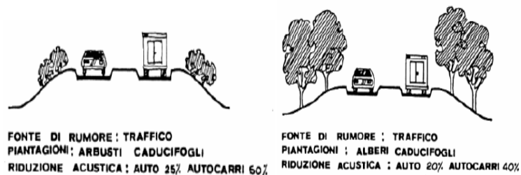
Fig.15: Vegetación dispuesta para el control acústico en vías vehiculares.
