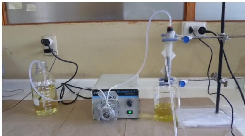
Figura 5-5. Conexiones entre el recipiente de almacenamiento, la bomba peristáltica y la columna de relleno.
