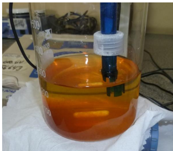
Figura 6-5. Precipitación de hidróxido de hierro (III) en solución acuosa a un pH superior a 5.
