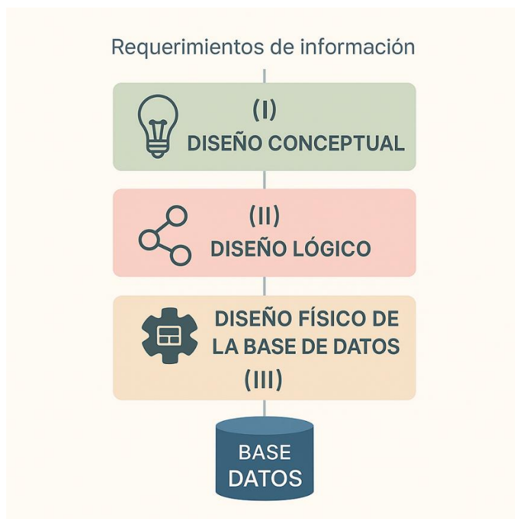
Ilustración 14: Etapas del diseño de una base de datos: diseño conceptual, lógico y físico.
