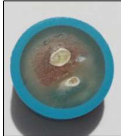
Figura 23. Muestra con lima cementada y cortada en su parte apical
