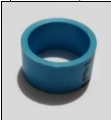
Figura 13. Tubos de PVC para montaje de muestras
