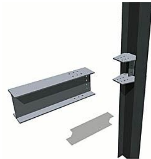
UNIÓN VIGA / PILAR DE MOMENTO APERNADA
