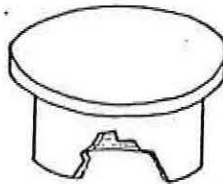
Figura No 7: Cilindro de acrílico con hilo labrado en sus paredes internas.
