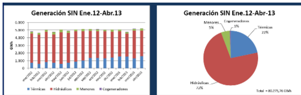
Figura N° 3. Generación en el Sistema Interconectado Nacional Colombia. Datos mensuales desde Enero 2012 a Abril 2013 (Operación del Sistema Interconectado Nacional Colombiano, 2013)
