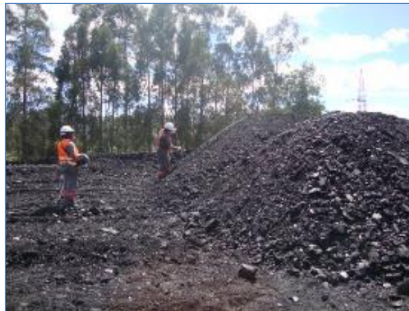
Figura N° 77. Toma de muestras para análisis de laboratorio y medición de Porcentaje de Ceniza. (Elaboración propia, 2014)
