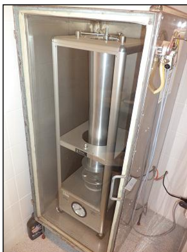
Figura 3: Vista frontal de Torre de Potter, en donde se dispersaron 2 mL de cada plaguicida sobre las respectivas placas Petri.
