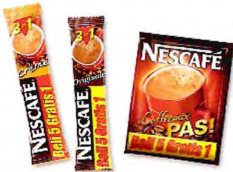
POLYESTER METALIZADO ADHERIDO A LAMINADO DE POLIETILENO
