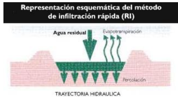
Figura 5.10 Esquema método de infiltración rápida (IGME)
