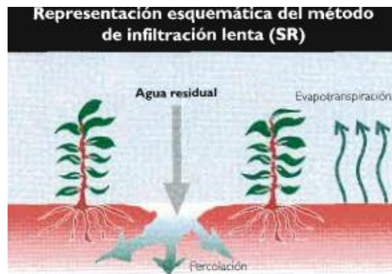
Figura 5.9 Esquema método de infiltración lenta (IGME)
