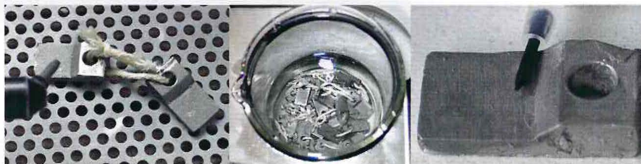
Fig. No.7: Procedimiento para el tratamiento superficial a base de arenado con óxido de aluminio. (a) Arenado, (b) limpieza en ultrasonido y (c) aplicación de silano.
