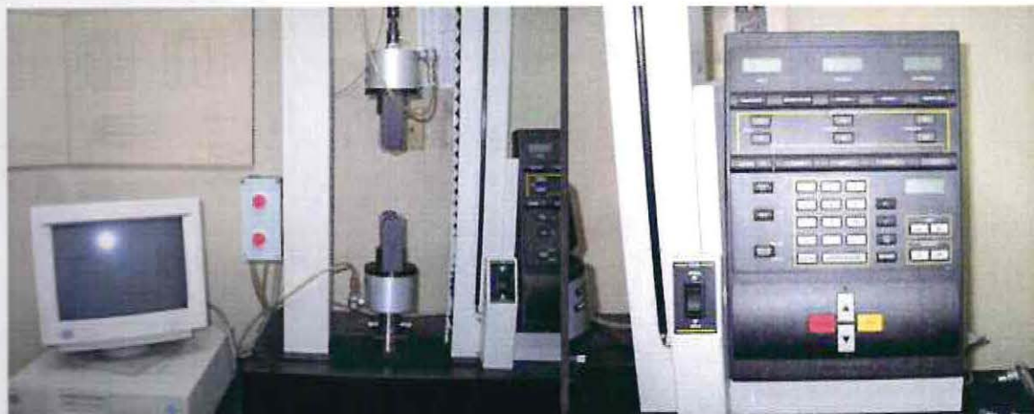
Fig. No.12: Máquina universal de pruebas donde se efectuaron las pruebas de cizallamiento.
