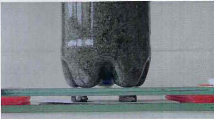
Fig. No.10: Pesa de 500 gr asentando los especimenes de trabajo.
