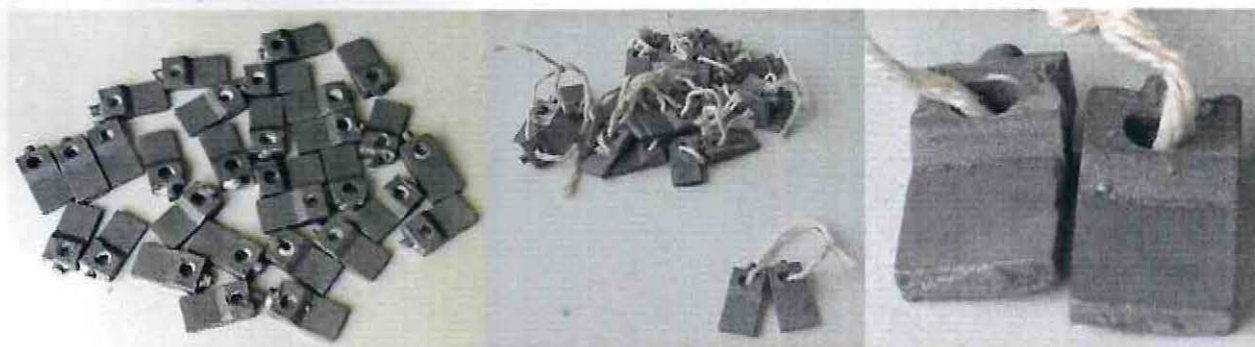
Fig. No.6: Especímenes colados, limpiados y pareados, listos para recibir tratamiento superficial.
