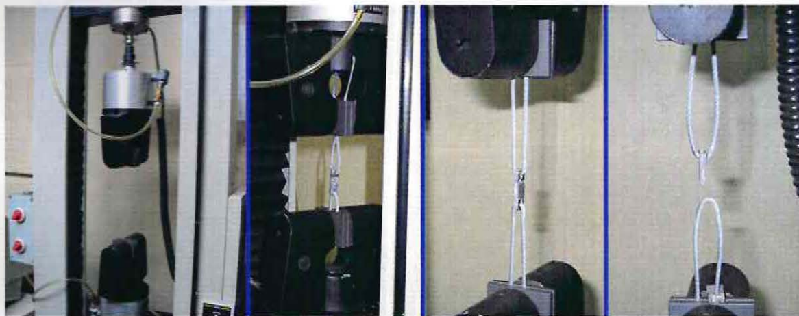
Fig. No.13: Secuencia de las pruebas de cizallamiento, desde su colocación, aplicación de fuerza y ruptura del espécimen.
