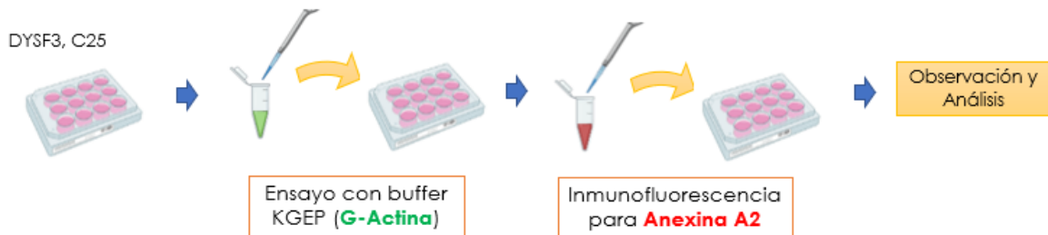
Figura 9. Esquema de la metodología utilizada en O.E.2. Se muestra el procedimiento experimental llevado a cabo, en donde las células son permeabilizadas con tampón KGEP con la utilización de G-actina en verde, para posteriormente realizarles una inmunotinción con un anticuerpo fluorescente rojo para AA2. Luego, las muestras son fotografiadas para finalmente llevar a cabo los análisis pertinentes.
