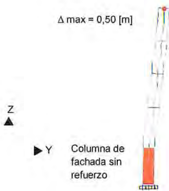
Figura 2.14 - Deformada sin refuerzo estructural
