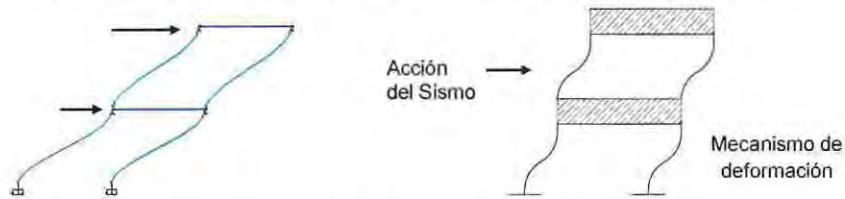
Figura 2.6 – Modelación y esquema de deformación de ejes interiores.
