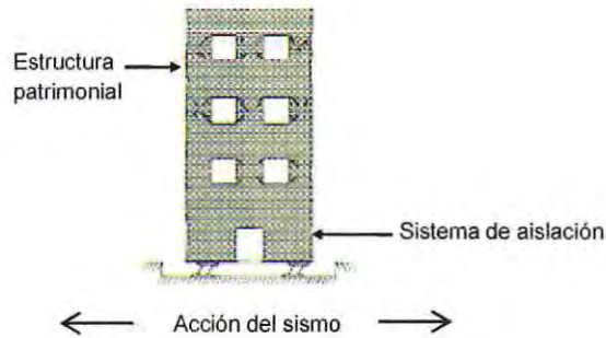
Figura 1.2 - Estructura con aislacion sísmica durante el sismo.
