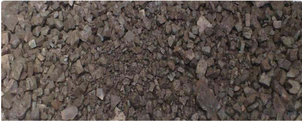
Figura 2: Escoria de Cobre en depósito de Ventanas.
