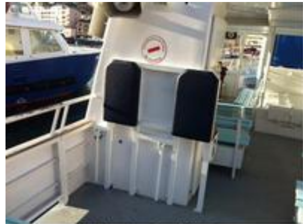
Plateforme d'accueil pour les 2 fauteuils
