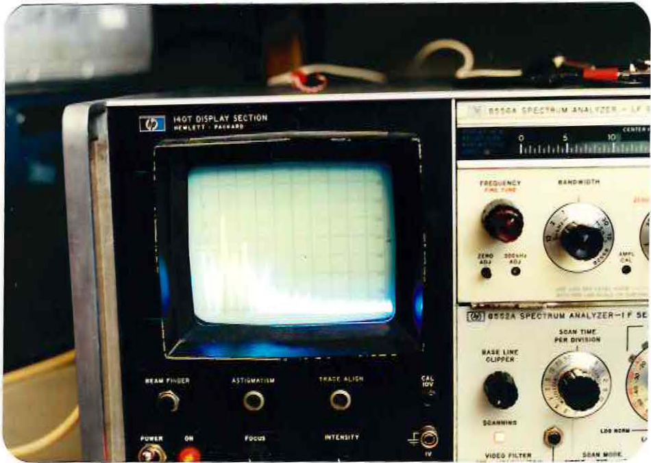
Fig. 27. Analizador de frecuencia: Se puede observar la señal de barrido escudriñando las frecuencias.
