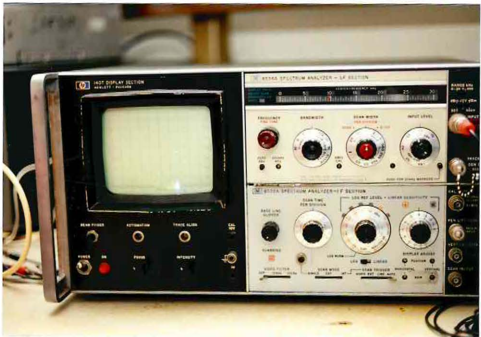
Fig. 23. Analizador de espectro (Hewlett-Packard 8556A). Se puede apreciar la señal de barrido en la pantalla del osciloscopio.
