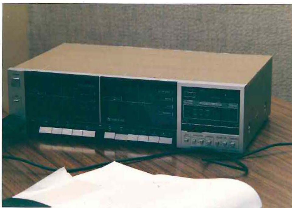
Fig.32. Se puede apreciar el Deck stereo CR-W77 marca Fisher utilizado en el test audiométrico.
