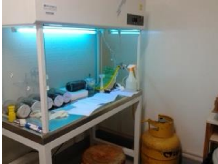
Figura 3.6.- Cámara de flujo con elementos necesario para proceder a la incubación de las probetas.
