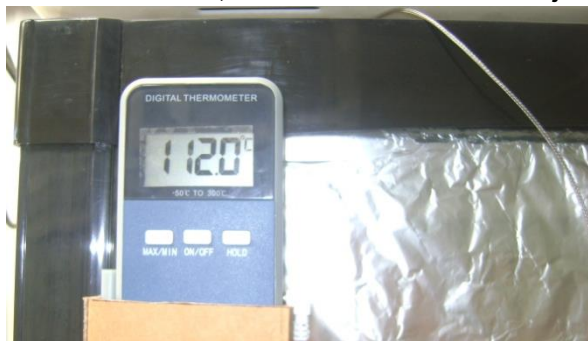
Figura 3.3.- Medición nº12, termómetro cámara de envejecimiento.
