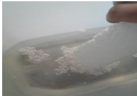
Figura 3.1. - Disolución del poliestireno expandido en d-limoneno.
