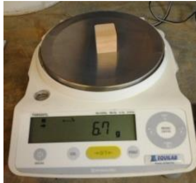
Figura 3.2- Determinación del peso de la madera con balanza analítica.
