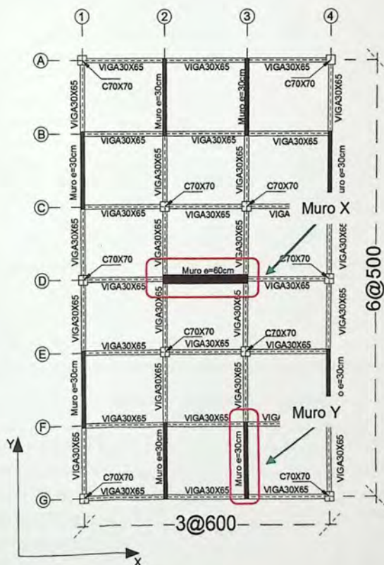
Figura 4.1- Planta estructura de estudio
