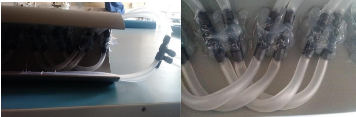
Figura 17. Distribución de aire. El sistema de distribución de aire se llevó a cabo por accesorios "T" unidos por mangueras, por las cuales se moverá el aire hacia otros accesorios "T".
