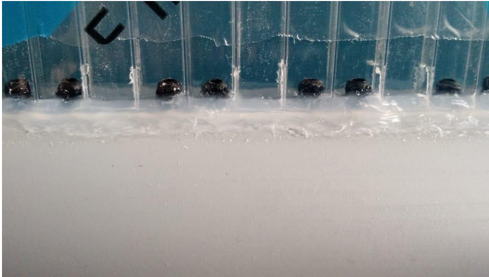
Figura 16. Entrada de aire al sistema. El ingreso de aire al sistema se llevó a cabo por grupos de dos celdas que poseen en su interior tubos "T", por una celda vacía.
