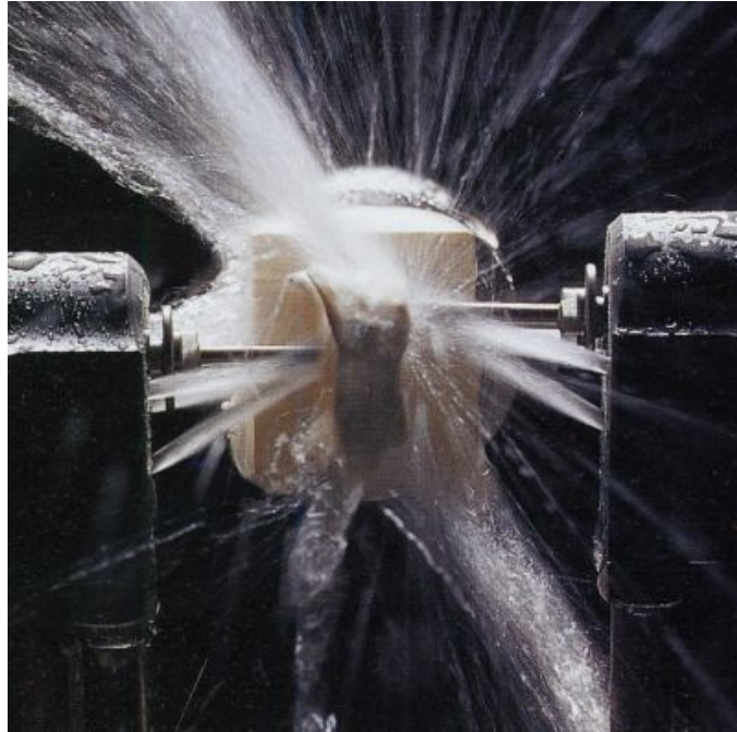
Figura 13. Tallado de un bloque de resina prepolimerizada.
