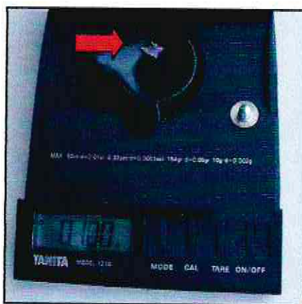
Fig.2.3 Determinación de volumen de tronera pesando impresión de troneras en silicona
