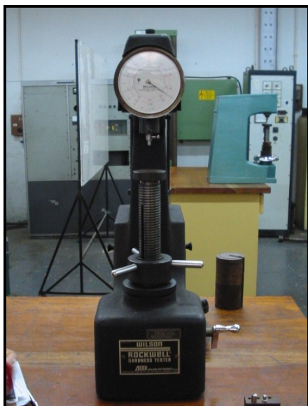
Foto 1. Máquina Rockwell Hardness Tester
