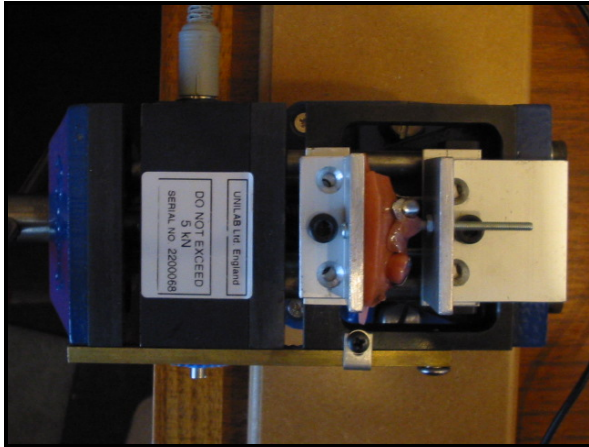
Foto 29. Pruebas de tracción
