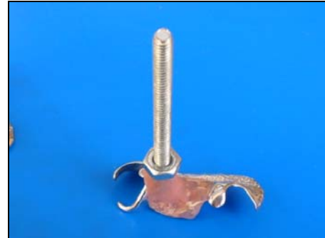
Foto 23. Cuerpo de prueba retenedor colado
