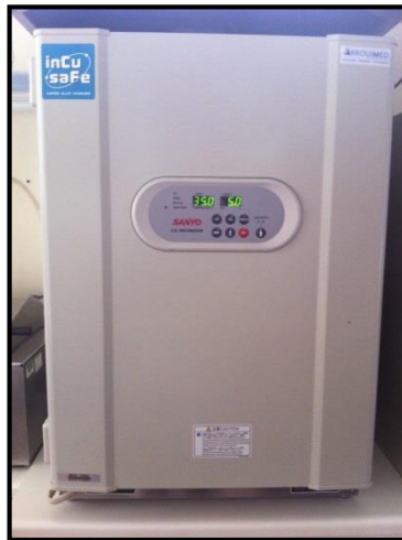
Figura 10. Estufa de cultivo con regulación automática de \text{CO}_2 .
