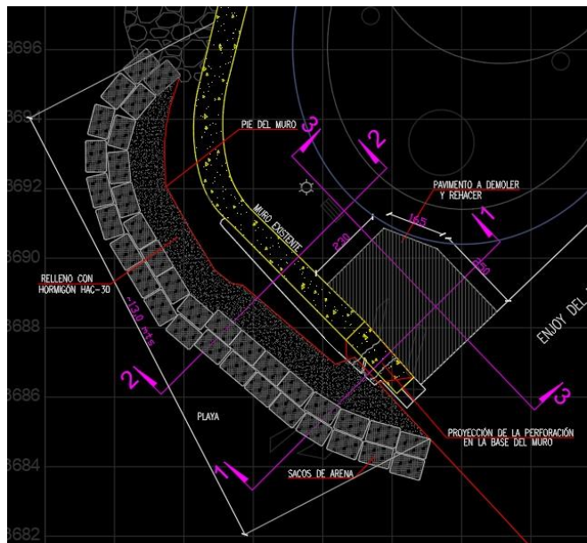
Ilustración 22: Vista en planta del muro reparado con HAC.
