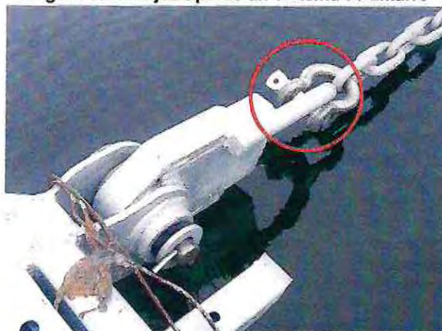
Figura 7: Herrajes tipo de un sistema de amarre
