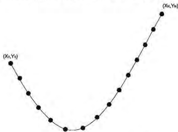
Figura 51: Formulación del sistema discreto de la catenaria.
