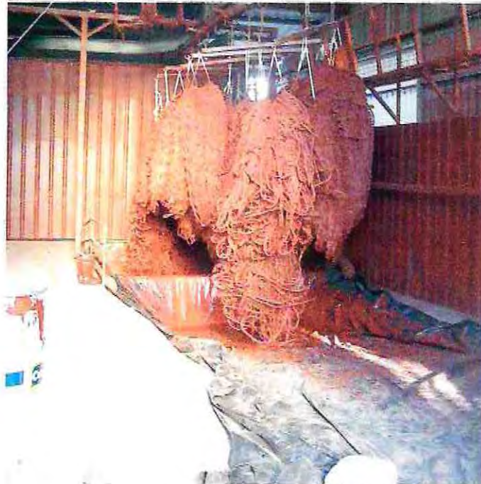
Figura 29: Aplicación de pintura anti-fouling a las redes peceras
