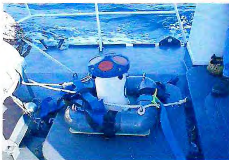
Figura 21: Correntómetro ADCP tipo, para correntometría euleriana.
