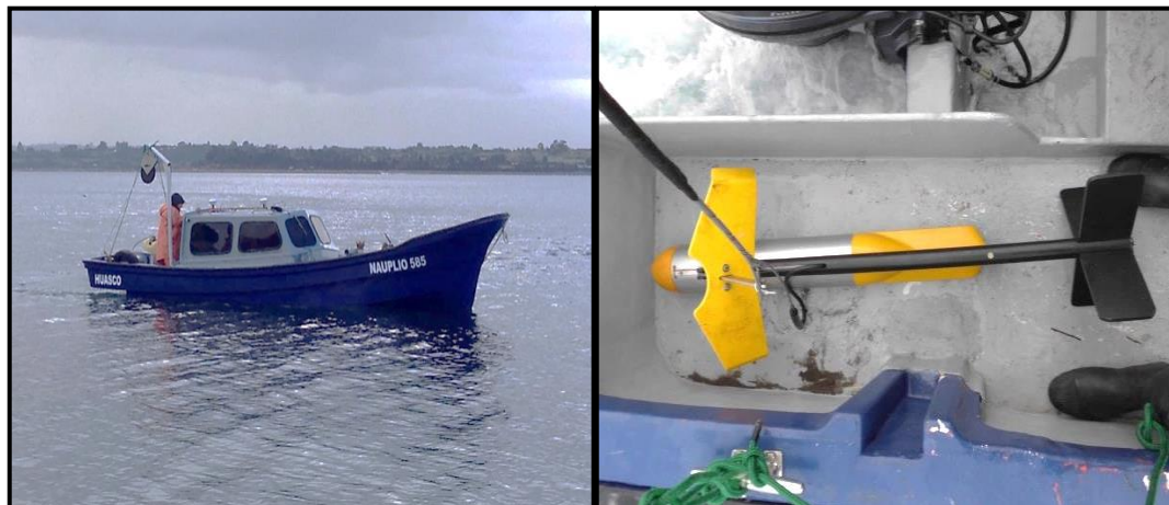
Figura 9.4-1: Embarcación usada para el levantamiento – Sonar de Barrido Lateral. Fuente: Elaboración Propia, utilizando cámara digital Sony.
