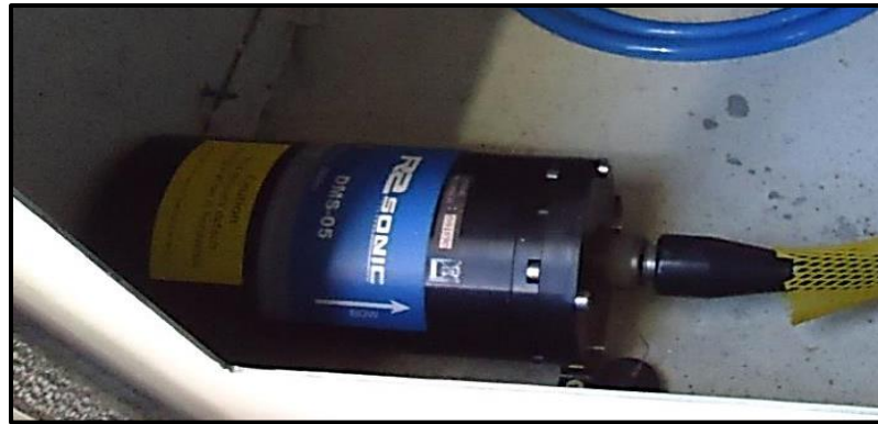
Figura 5.1-6: Sensor de movimiento TSS DMS 05. Fuente: Elaboración Propia, utilizando cámara digital Sony.
