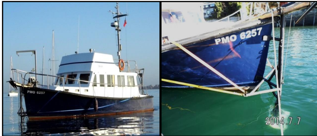
Figura 9.2-1: Embarcación usada para el levantamiento multihaz. Fuente: Elaboración Propia, utilizando cámara digital Sony.
