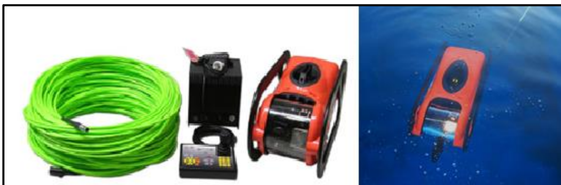
Figura 5.5-3: ROV y accesorios (umbilical, fuente de poder y caja de control); ROV sumergido. Fuente: Elaboración propia, utilizando cámara digital Sony.
