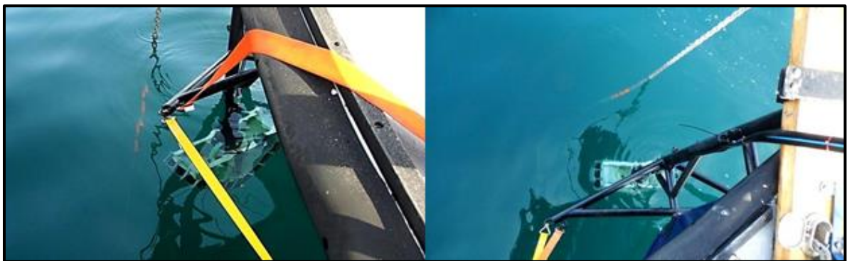
Figura 5.1-5: Soporte de acero y transductor instalados al costado de la embarcación. Fuente: Elaboración Propia, utilizando cámara digital Sony.
