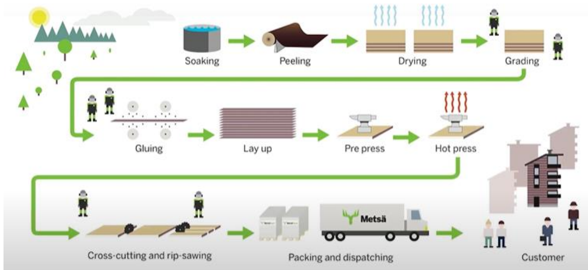
Figura 2.5 – Proceso de manufactura de LVL según la empresa Metsä Wood Kerto® [25].
