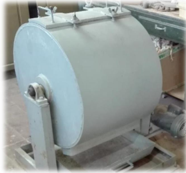
Figura 4.4 Equipo, Desgaste de los ángeles, Universidad de Valparaíso, Fuente: Elaboración propia (2018)
