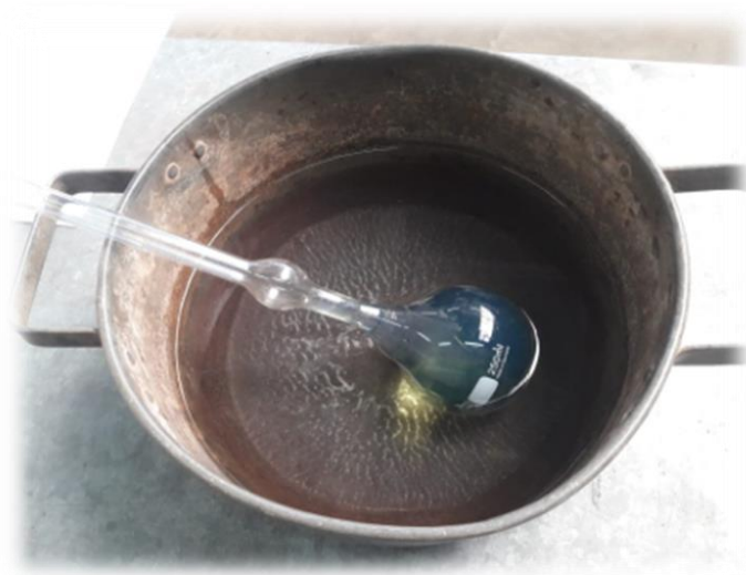
Figura 4.7 Matraz Le Chatelier con material sin calcinar
