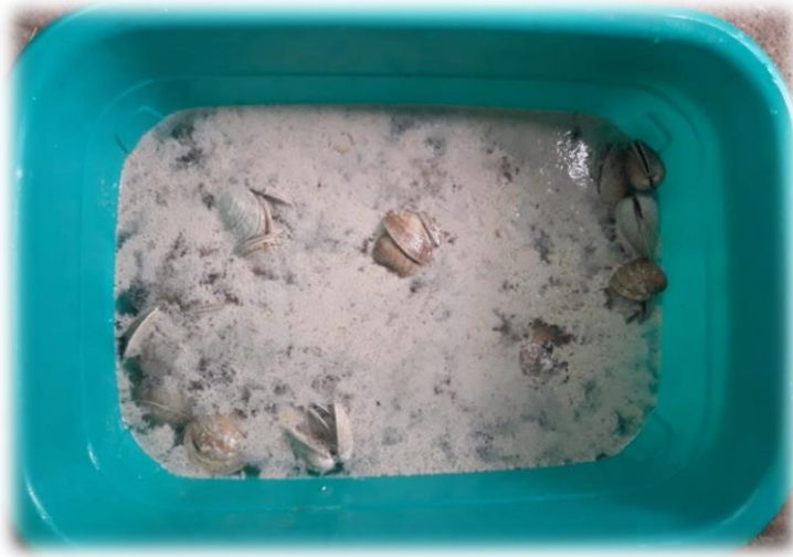
Figura 4.2 Lavado de concha de almeja con soda cáustica, Fuente: Elaboración propia (2018)
