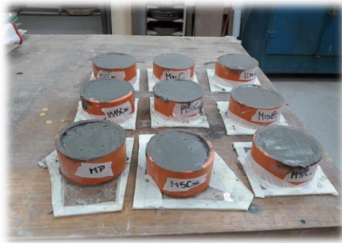
Figura 4.13 Ensayo de tiempo de fraguado, elaboración propia (2018).
