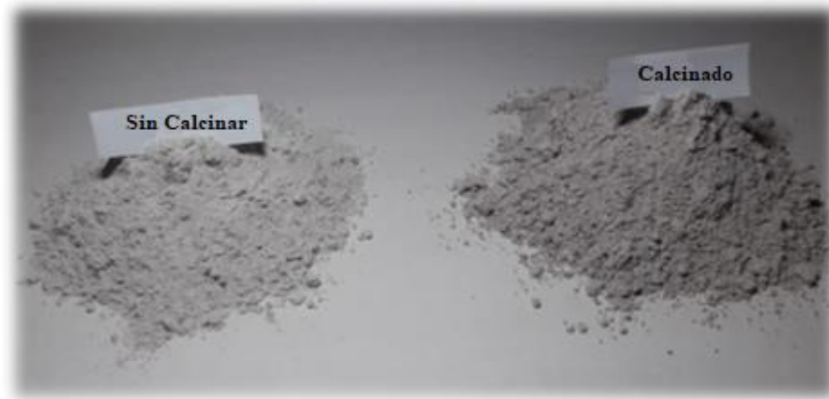
Figura 4.6 Material - sin calcinar y calcinado, Fuente: Elaboración propia (2018)
