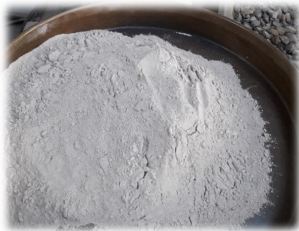
Figura 4.5 Tamizado de concha de almeja por malla N° 200, Fuente: Elaboración propia (2018)
