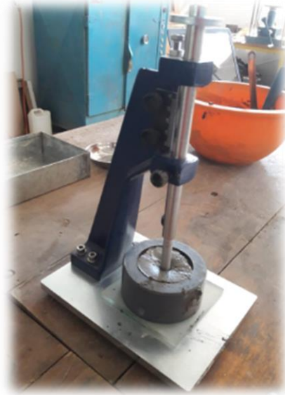
Figura 4.11 Ensayo de Consistencia normal "Muestra Patrón"
