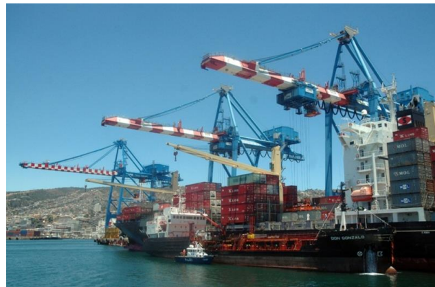
Grúas tipo pórtico Gantry
