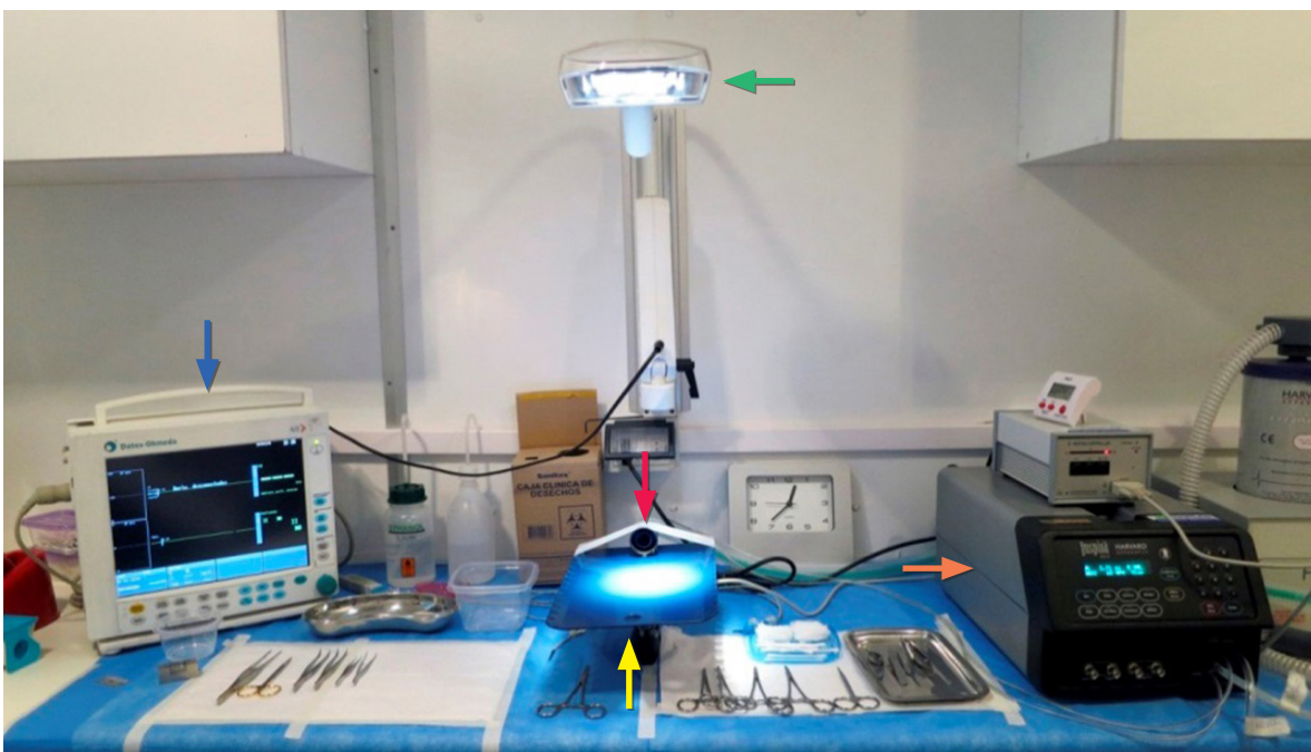
Figura 7. Sala de microcirugía. Tabla operatoria temperada [Flecha amarilla]; máscara de anestesia para ratas [Flecha roja]; ventilador mecánico Inspire [Flecha naranja]; monitor cardiaco [Flecha azul], lámpara quirúrgica [Flecha verde].
