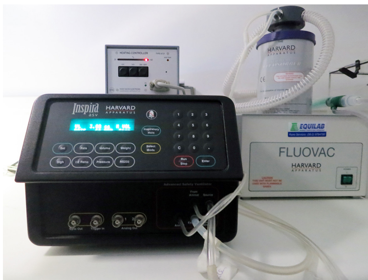
Figura 13. Izquierda, ventilador Inspira ASVV, Harvard Apparatus, USA, volumen/control. Derecha, sistema de seguridad FLUOVAC, para la recolección de residuos anestésicos.
