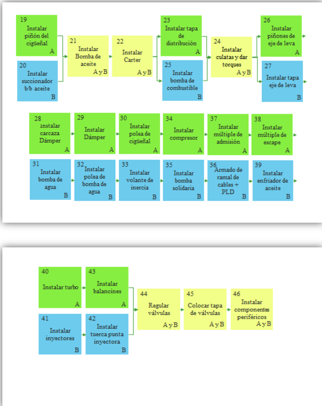
Figura 18. Trabajos simultáneos proceso de armado
