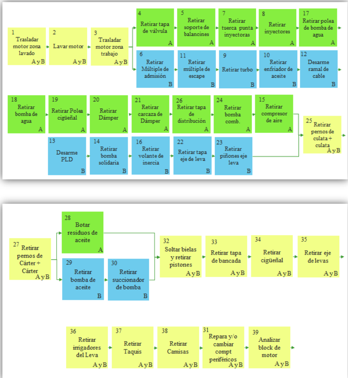
Figura 17. Trabajos simultáneos proceso desarmado
