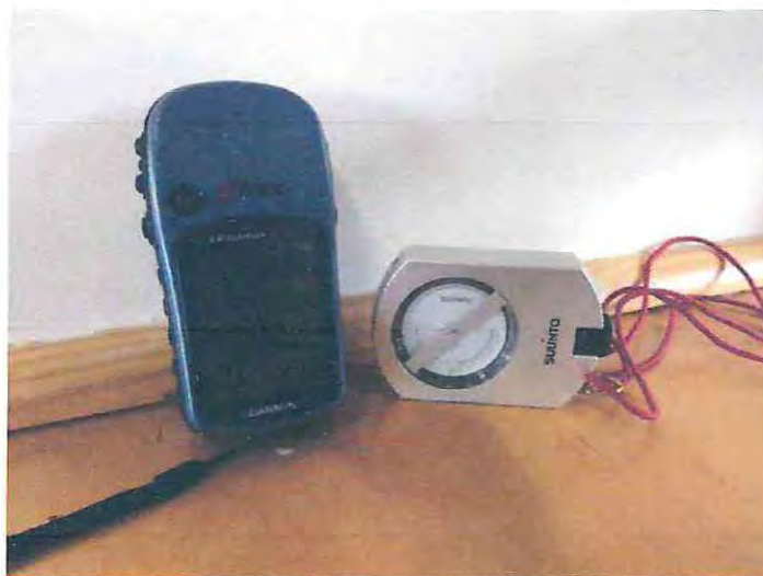
Figura 19: Equipo utilizado para georreferenciar la zona destinada para implementar la cancha de compostaje y medir su pendiente.
