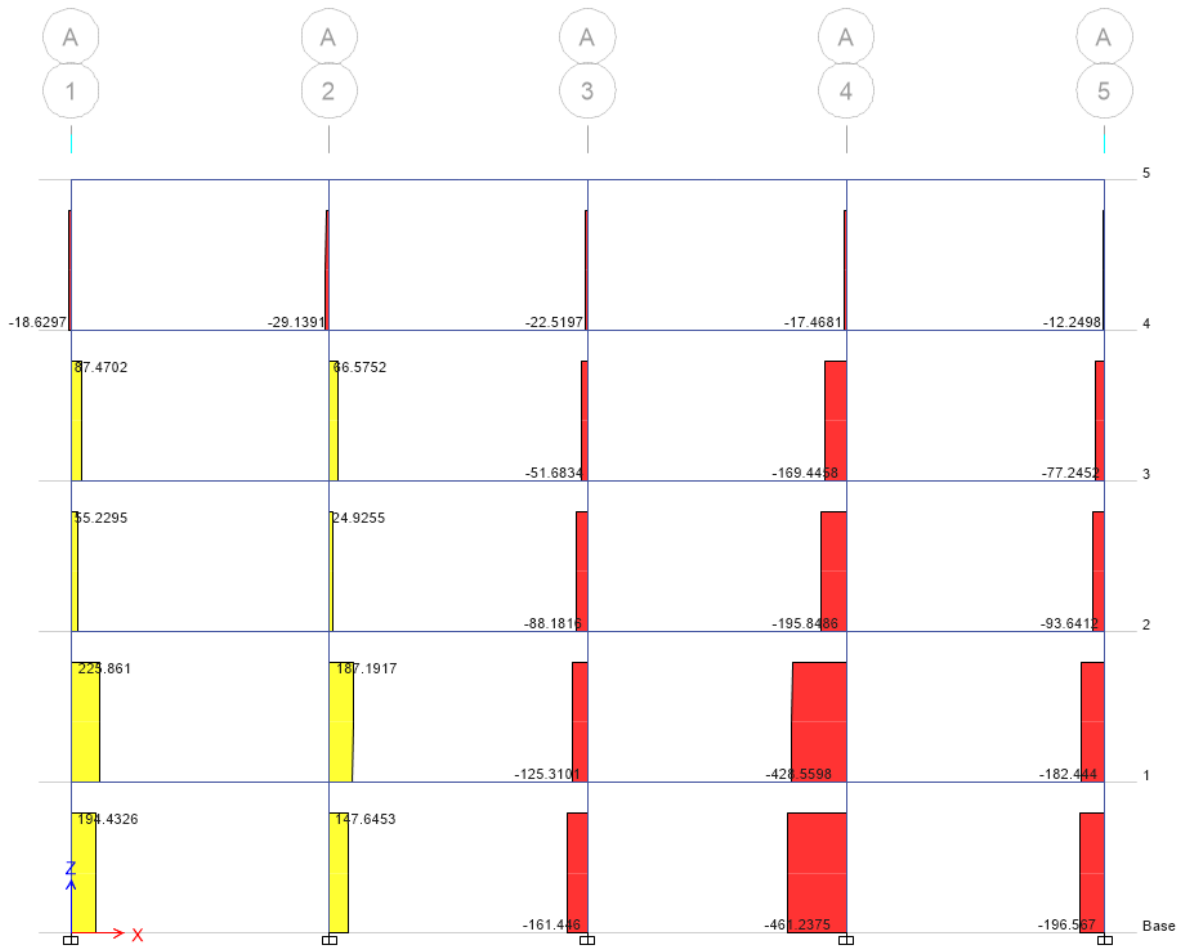
figura 5.8 – Diagrama de fuerza axial para la combinación de carga 1.2DL + 1.0LL + CP, para el eje A de la estructura
