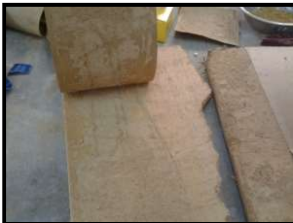
Figura 4.10 Prueba Promotor de Adherencia Cola Fría diluida en agua. Fuente, Elaboración Propia
