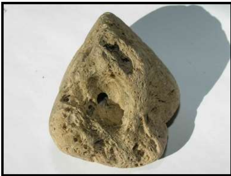
Figura 2. 9 Características Morfológicas de piedra Pómez, Fuente: Elaboración Propia
