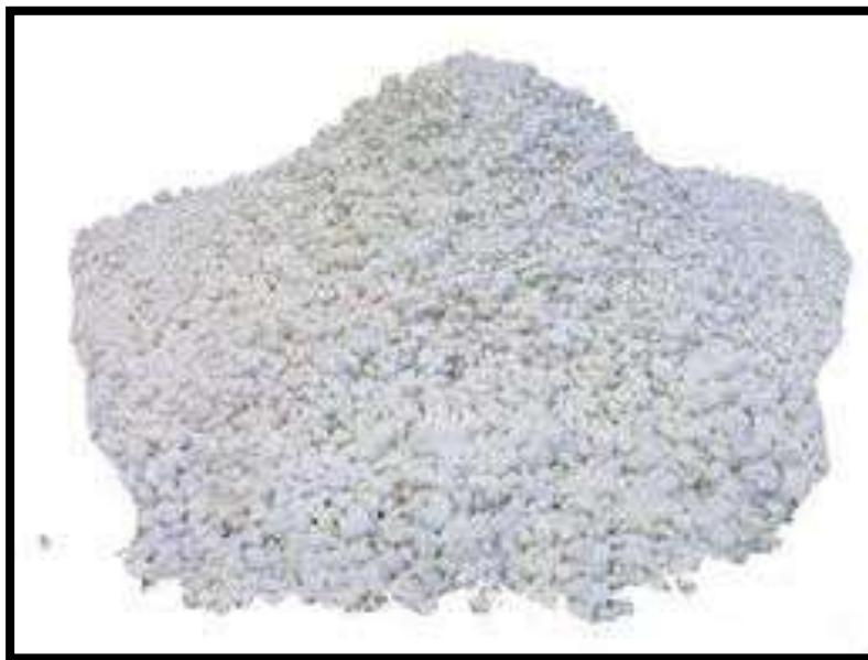
Figura 2.6 Características Morfológicas de las Perlitas Expandidas. Fuente: Elaboración Propia
