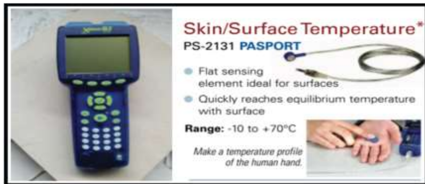
Figura 3.4 Equipo Xplorer y sensores de temperatura, Fuente: (Pasco, 2012)
