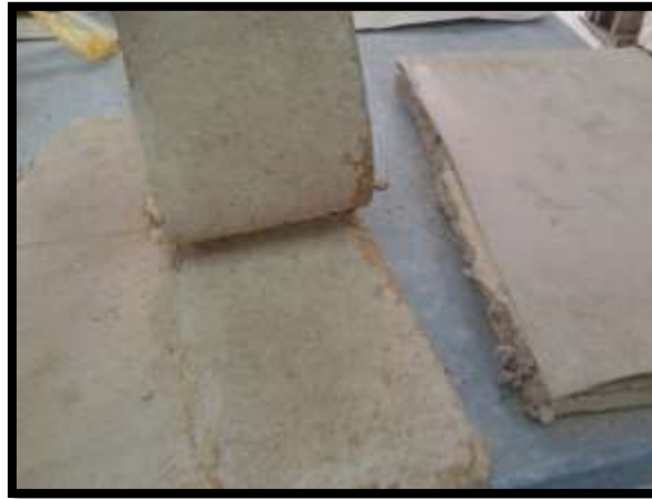
Figura 4. 8 Prueba Promotor de adherencia, Cola Granulada. Fuente, Elaboración Propia
