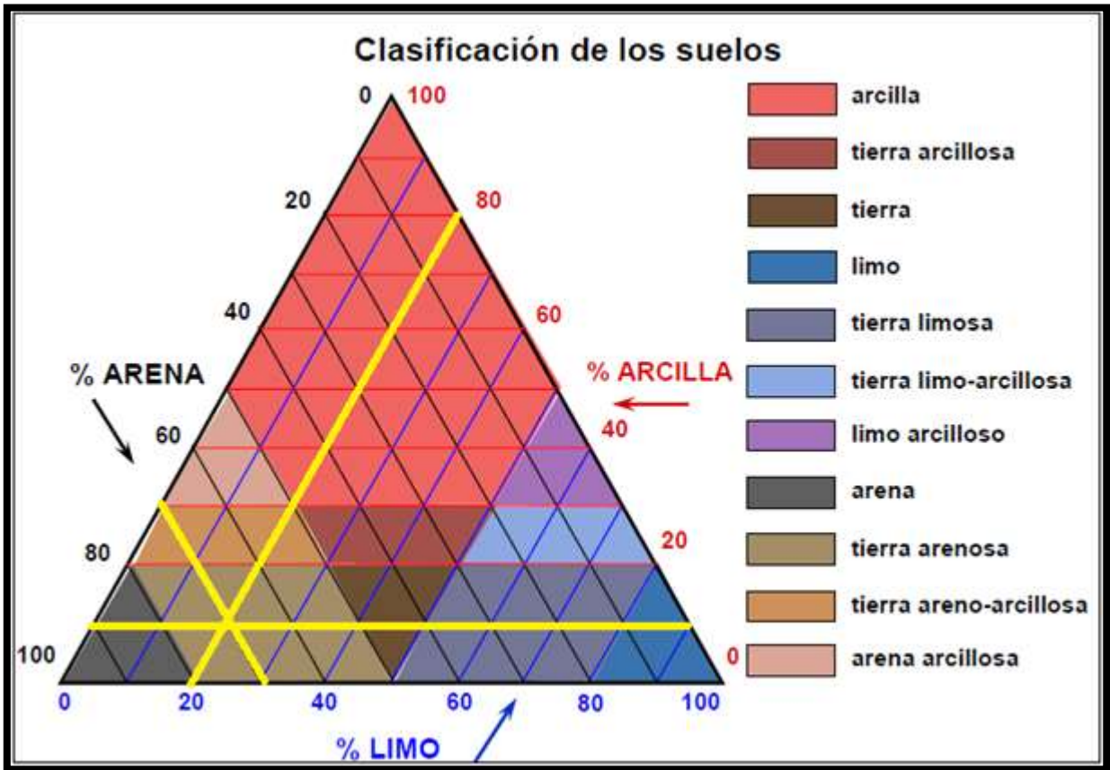
Figura 2. 2 Diagrama de Clasificación de los Suelos. Fuente (Martíns et al., 2009)
