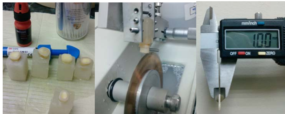
Figura 1: Proceso de corte y medición de las barras de muestra.
